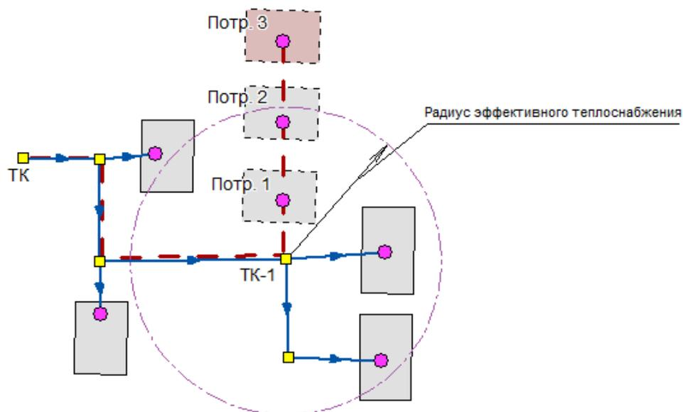
Рисунок 2 - Расчетная модель системы теплоснабжения
