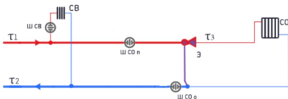
Рисунок 3 – Схема подключения потребителей к двухтрубной тепловой сети (при наличии внутренней системы отопления), в качестве регулятора температуры используется элеватор (CO – система отопления, Э – элеватор, СВ – система вентиляции)
